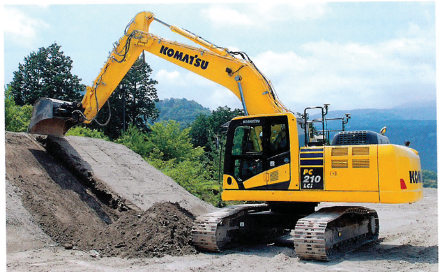
Der 22-Tonner PC210LCi-10 gilt als erste Erdbaumaschine, die ab Werk serienmäßig mit einer Maschinensteuerung ausgestattet ist. (Bild: Komatsu)
