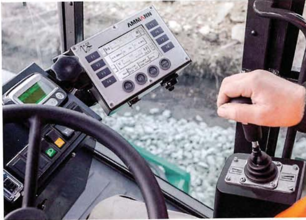
Ammann Compaction Expert für Walzenzüge und Tandemwalzen passt die Verdichtung durch automatisierte Einstellungen an wechselnde Einsatzbedingungen an. (Bilder: Ammann)
