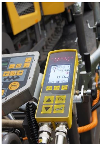
Auf dem Display der MOBA-matic II Bedieneinheit wird die Temperatur des Sensors ständig angezeigt
